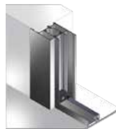
E: Montage in de dag met afdekljst binnen
